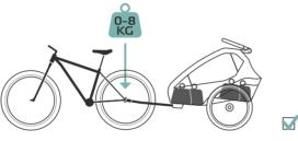
Eine optimale Stützlast ermöglicht ein sicheres Fahrverhalten.
