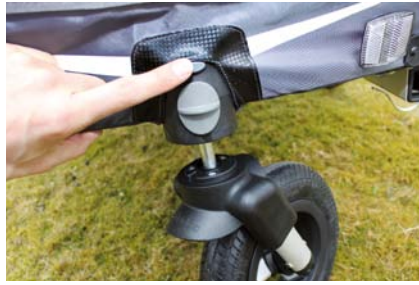
Buggyrad: läuft jetzt unter dem Wagen und hält ihn gut in der Spur.
